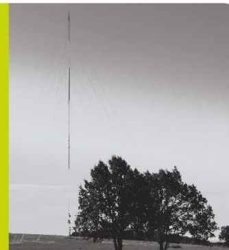
Les instruments en place sur le mât de mesure ont permis d'estimer une vitesse moyenne représentative à 100 m de hauteur supérieure à 7 m/s.
